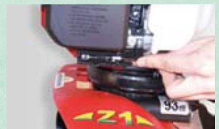
Gaszug mit Stoppkabel am Motor einhängen und verriegeln
